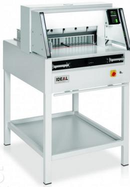
Massicot compact Ideal 4860 pour la coupe des imprimés numériques, équipé d'un écran de commande tactile et programmable.
