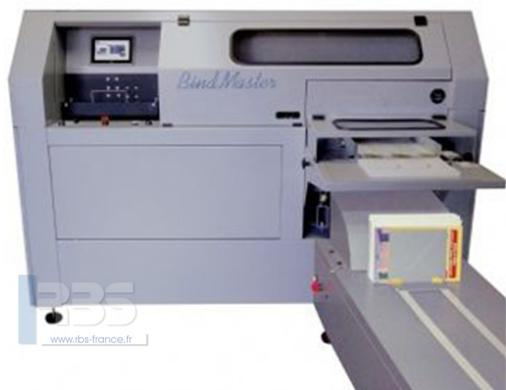
Thermorelieur haut rendement pour dos carré collé Bindmaster 2 B150 EVA, thermorelieuse automatique de production conçu pour les moyennes et petites séries avec une sortie motorisée.
