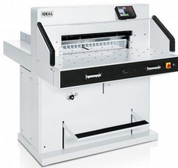
L'Ideal 7260 est un massicot industriel presse hydraulique. Disposant de nombreux accessoires et fonctionnalités très pratiques, il vous permet la coupe rapide et sécurisée d'une largeur de coupe jusqu'à 720 mm. 99 réglages de coupe sont programmables.
