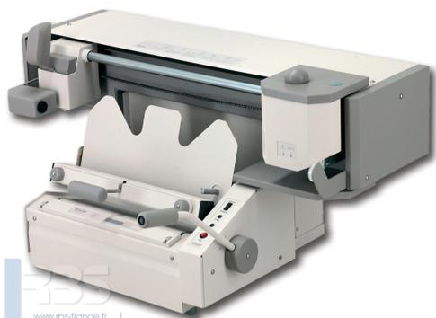
Thermoreliure compact pour dos carré collé Optima, thermoreliure par collage à chaud pour une grande variété d'applications, du bloc-notes au livre sous couverture rigide avec toujours un dos carré collé parfait.
