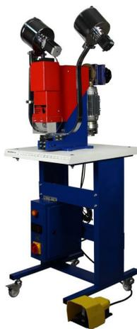
Presse pneumatique 100% automatique à œillets. La presse MAM500 pour la pose d'œillets entièrement automatique : double chargeur pour œillets et contre-partie, envoi des œillets et contre-parties, perforation de la matière et sertissage simultanés de l'œillet.
