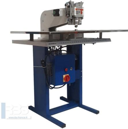
La MAMH5 DTS est une machine hydraulique de fixation d'oeillets de grande taille (jusqu'à 28 mm) sur des matières épaisses et résistantes.
