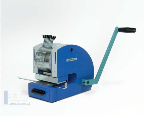
Perceuse à commande manuelle et bloc de roues réglables. Jusqu'à 6 roues numérotées en standard avec leviers fixes.
