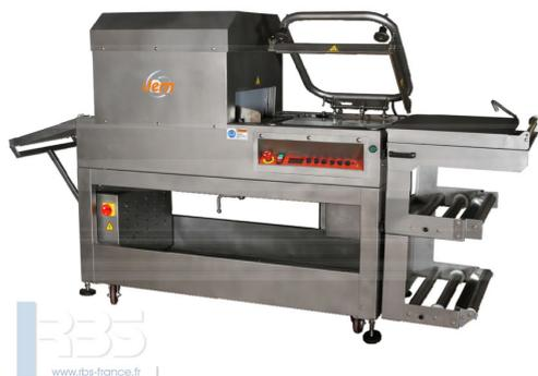
Filmeuse alimentaire GP 4 APM version inox 316 spécialement conçue pour l'alimentaire format 470 x 555 mm, hauteur max. 200 mm, avec abaissement pneumatique du bras de soudure, cadencement automatique possible pour travailler par cycle et sortie automatisé.
