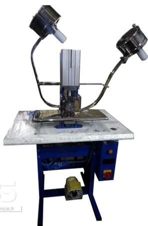
Presse pneumatique 100% automatique à oeillets : la MAM900 alimente l'oeillet et la contre-partie, perce le trou dans le matériau et fixe l'oeillet à la contre-partie.
