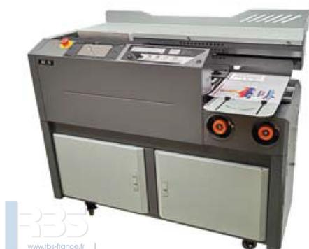
Avec l'AUTOBINDER Compact, vous allez pouvoir réaliser des reliures dos carré collé de haute qualité avec les mors collés. Des documents reliés pouvant aller jusqu'à la taille A4, produits rapidement avec un système d'encollage performant.
