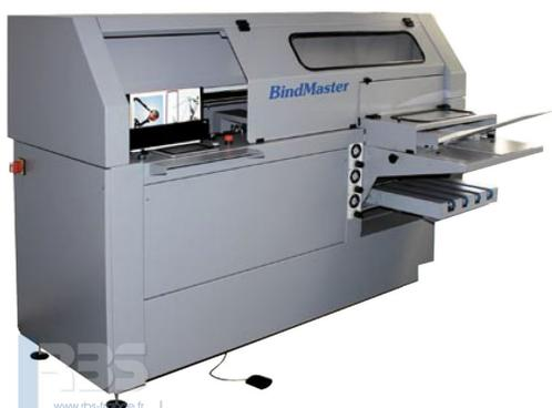
Thermorelieur haut rendement pour dos carré collé Bindmaster 2 pour colle EVA, thermorelieuse automatique de production de dos carré collé.
