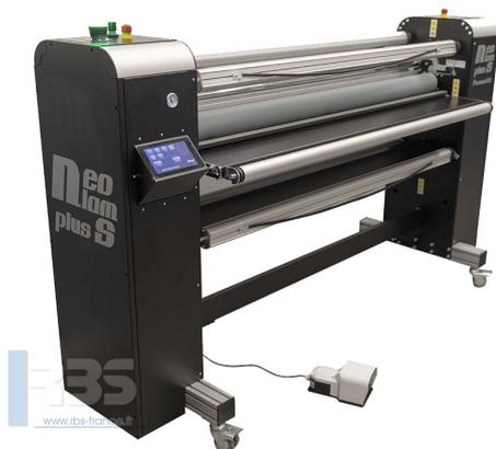
Lamineur à rouleau supérieur chauffant NEOLAM Plus 2050 C pour une solution de plastification à froid parfaite pneumatique qui s'adapte automatiquement à vos supports les plus délicats.
