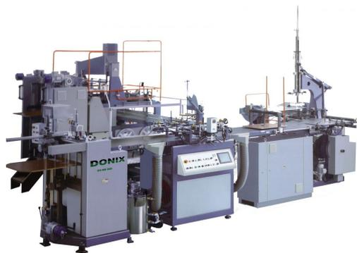
La DONIX RB600 est une chaîne de production automatisée pour la fabrication de boîtes rigides
