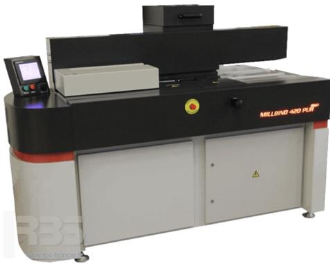
Thermorelieuse - MILLBIND 420 PUR. Thermorelieur par collage à chaud. Machine à relier en dos carré collé.
