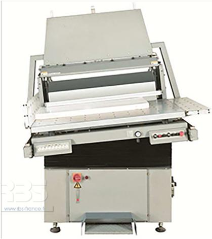
Les taqueuses avec chasseur d'air "AR" sont souvent utilisées par les imprimeurs d'étiquettes
