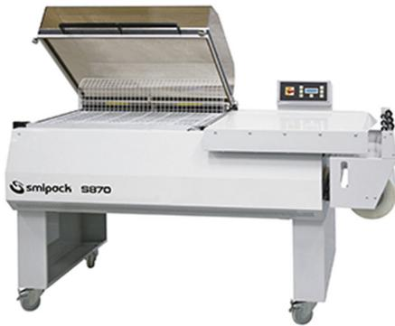
Fimeuse RBS - S870. Machine de conditionnement en L à cloche. Barre de soudure 870x 620 mm. Format maxi colis L 830 x l 600 x H 310. Production moyenne par heure 200-300 pièces. Dimensions de la bobine : 800 x 300 mm.
