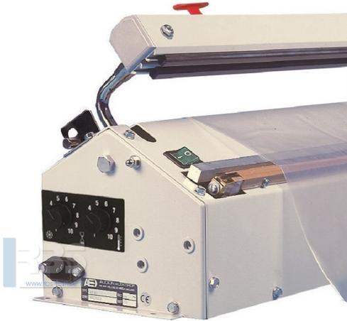
Soudeuse avec verrouillage par électro-aimant, peut être commandée par pédale, système de coupe et contrôle du temps de soudure et de refroidissement par minuterie. Longueur de soudure de 1020 mm sur 5 mm de large.
